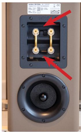
Über drei direkt am Anschluss-terminal platzierte Kippschalter (siehe Pfeile) lässt sich die Tief-, Mittel- und Hochtoncharakteristik der 140er an den eigenen Hörgeschmack bzw. die räumlichen Gegebenheiten anpassen.
