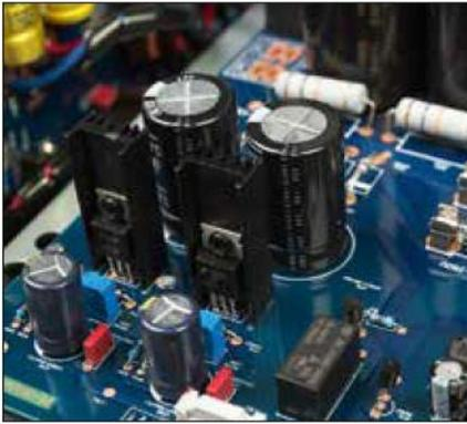
Groß im Bild die beiden Siebkondensatoren für die Eingangsstufe. Sie eliminieren die Pulsartefakte, die in gleichgerichteter Wechselspannung noch zu finden sind
