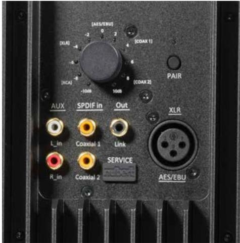
Das Anschlussfeld ist zeitgemäß und vollzählig: Aux-In, zweimal S/PDIF sowie AES/EBU. Über die „Out“-Buchse wird „der andere“ Lautsprecher versorgt, umschalten lassen sich die Quellen über einen griffigen Encoder. Rechts daneben liegt die Pairing-Taste: Gedrückt halten, bis die LED an der Gehäusefront blinkt, dann rüber zum zweiten Kanal und dessen Taste einmal kurz drücken – schon steht die hervorragende Hochbit-Funkverbindung.
